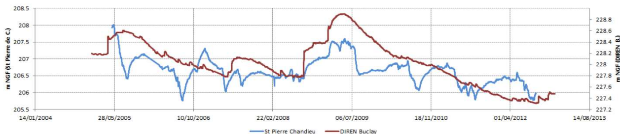
Figure 3 : Evolutions piézométriques simultanées entre la molasse (en bleu) et les alluvions fluvio-glaciaires (en rouge) au niveau du couloir de Heyrieux amont
